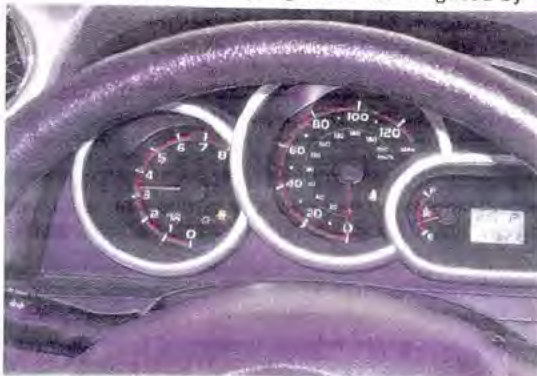
アクセル引っ掛かり時のメーター表示 Display on the meter when the pedal was sticking.
